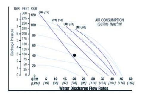
As vazões indicadas no gráfico foram determinadas pelo bombeamento de água.
